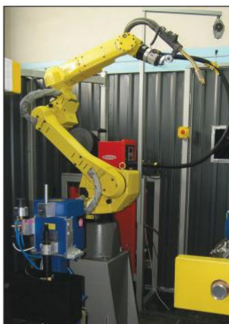
Рис. 2. Изделия типа «подкладка с упором» (а) и «подкладка с подушкой» (б) в позиции загрузки под сварку роботом
