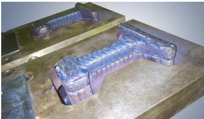
Рис. 3. Наплавленные роботом торцы рельсов
