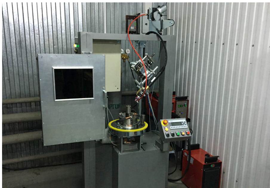
Рис. 2. Установка АС 399-С1 для зварювання кільцевого шва корпусу
