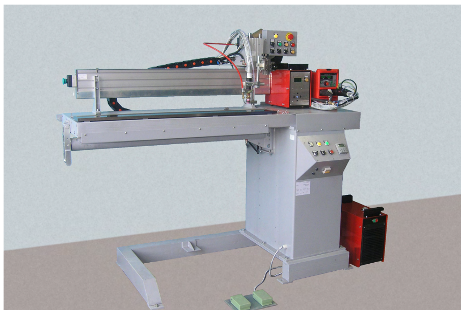
Рис. 1. Установка АС 333 для зварювання поздовжнього шва обичайки
